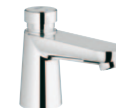
36 265 000 Euroeco CT Selbstschluss-Standventil, DN 15 Markierung blau/rot Laufzeit einstellbar auf 7, 15 und 30 sec
