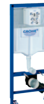
38 528 001 Rapid SL für WC mit Spülkasten GD2 Start/Stopp oder 2-Mengen (6 l / 3 l) Vorwand oder Ständerwandmontage Bauhöhe 1,13 m
