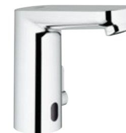
36 413 000 Eurosmart Cosmopolitan E Bluetooth Infrarot-Elektronik für Waschtisch DIN 15 mit Mischung und variabel einstellbarem Temperaturbegrenzer mit Infrarot-Sensor und Bluetooth®-Modul für bidirektionale Kommunikation mit Steckertrafo 100–240 V AC GROHE EcoJoy 5,7l/min Mousseur
