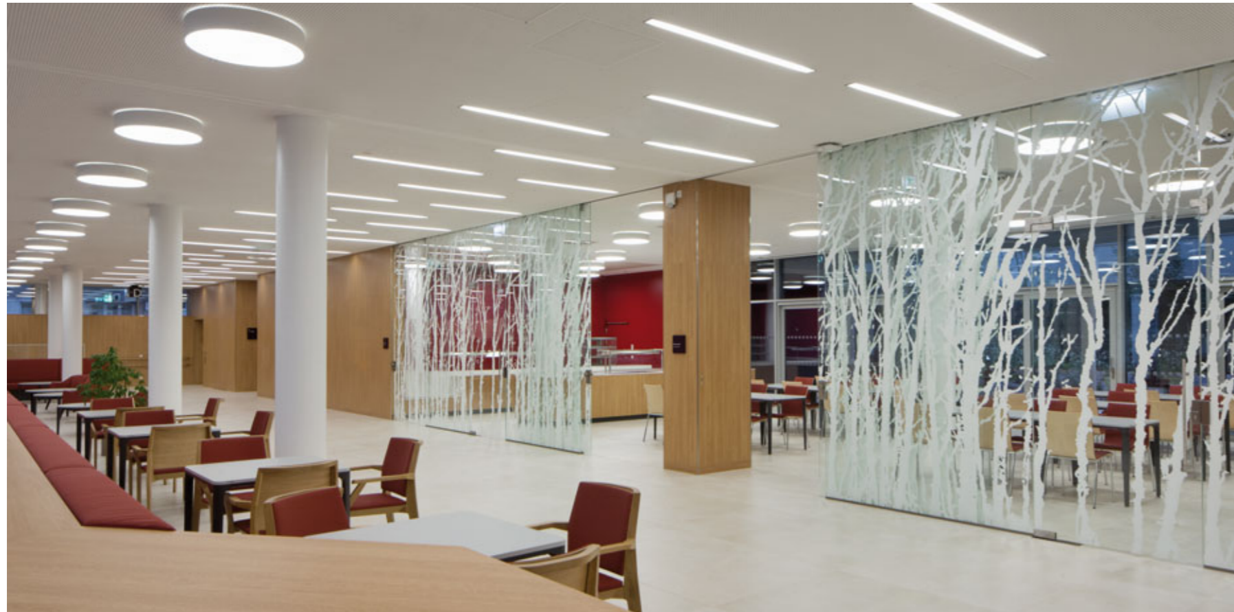
Altersgerechtes Lichtkonzept: Ältere Menschen sehen oft schlecht und benötigen eine höhere Beleuchtungsstärke von 500 Lux.
