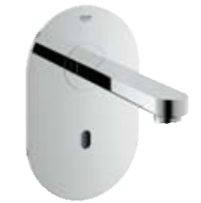
36 410 000 + 36 336 000 Eurosmart Cosmopolitan E Bluetooth Infrarot-Elektronik für Waschtisch ohne Mischeinrichtung mit Infrarot-Sensor und Bluetooth®-Modul für bidirektionale Kommunikation Laminarstrahlregler 9 l/min Ausladung 172 mm + seperatem Unterputzkörper mit Trafo 100-240 V AC, 6,75 V DC nach Ausladung 172 mm hinzufügen 36 334 SDO ohne Bluetooth, Edelstahl
